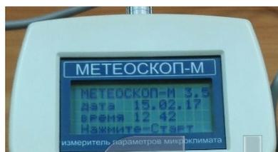
Нажмите кнопку «Старт», после чего запустится процесс автотестирования, который включает в себя проверку условий окружающей среды, проверку напряжения на аккумуляторных батареях и тестирование внутренних цепей прибора. Результаты отображаются на экране:
