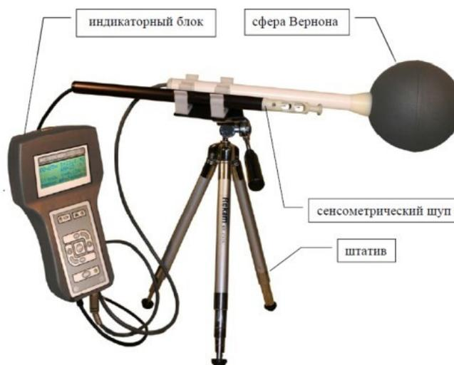
**Рис. 3.** Метеоскоп-М
