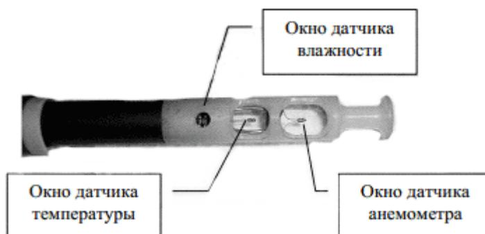
**Рис. 4.** Сенсометрический щуп
