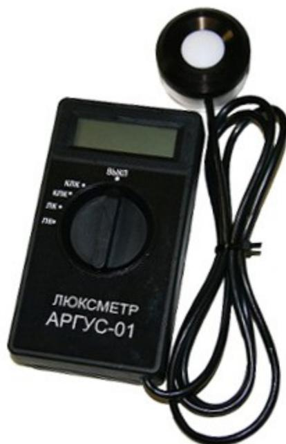
**Рис. 9.** Прибор люксметр «Аргус-01»
