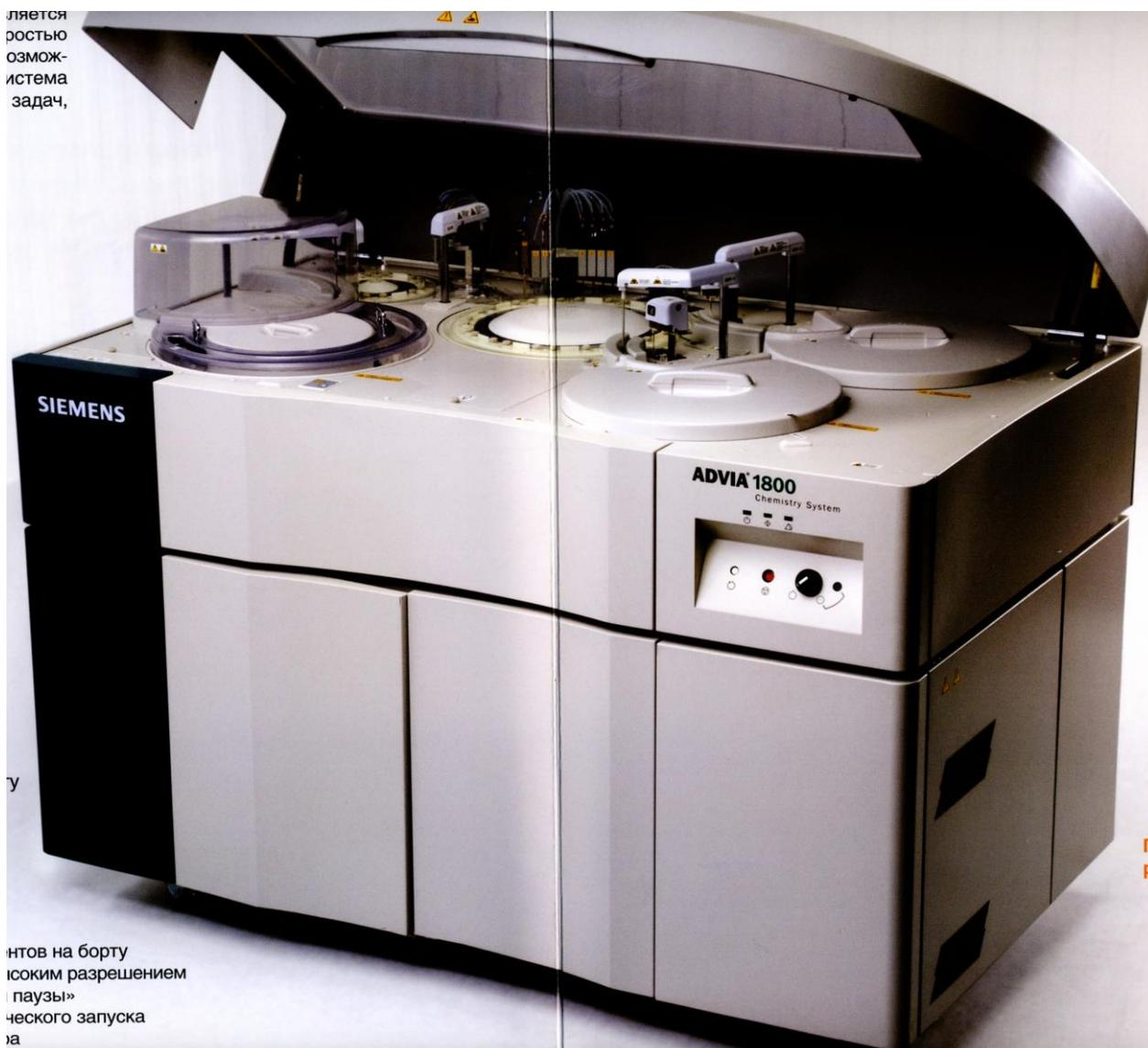
Высокопроизводительный (1800 проб в час) автомат с открытой системой использования реактивов. Используется в специализированных клинических лабораториях, крупных клиниках или центрах.
