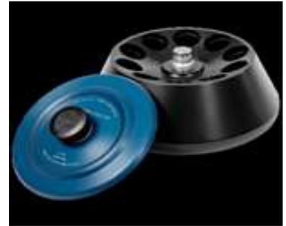
Угловые роторы удерживают пробирки под углом к оси вращения. Величина этого угла у каждого ротора своя и, как правило, укладывается в диапазон от  $25^\circ$  до  $40^\circ$ .
