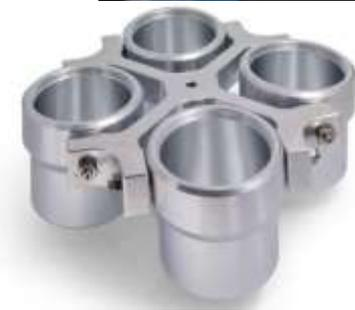
Горизонтальные роторы называются так потому, что их стаканы или штативы, которые удерживают центрифужные пробирки, благодаря особому креплению под действием центробежных сил могут подниматься в горизонтальное положение.
