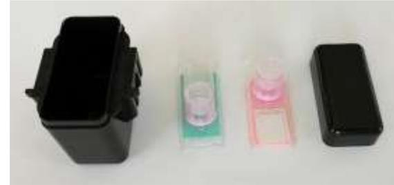
Центрифугирование крови при подготовке препаратов для исследования клеточного материала под микроскопом производится в цитороторах – сложных устройствах, комплектуемых держателями образцов и предметных стекол различной конструкции. От устройства циторотора и характеристик центрифуги напрямую зависит качество образца, и, следовательно, информативность результатов анализа.
