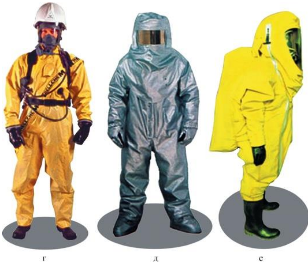
Рис. 25.1. Спецодежда: г - костюм «Треллкем Супер», тип Т. Изолирующий костюм предназначен для защиты от аварийно-химически опасных веществ в жидкой и газообразной форме при проведении аварийно-спасательных и газоопасных работ. Костюм оснащен системой вентиляции подкостюмного пространства, вшитыми сапогами со стальным носком и защитой от проколов (вшитыми носками), газонепроницаемой молнией, специальными перчатками; д - комплект защитный аварийный (КЗА) предназначен для комплексной защиты при воздействии открытого пламени, инфракрасного излучения, сильнодействующих ядовитых веществ. Комплект используется в сочетании с дыхательным аппаратом, размещенным в подкостюмном пространстве; состоит из двух комбинезонов: теплоотражательного и теплоизолирующего. Для защиты глаз комбинезон снабжен специальным панорамным стеклом. Комплект надевается на рабочую одежду и обувь; е - радиационно-защитный комплект одежды «РЗК» для пожарных. Комплект предназначен для индивидуальной комплексной защиты пожарного при тушении пожаров и проведении аварийно-спасательных работ в зоне сочетанного \alpha - и \gamma -облучения, повышенных температур, тепловых потоков, проникновения (инкорпорации) радиоактивных газов и аэрозолей через дыхательные пути и пищеварительный тракт, а также радиоактивного загрязнения кожи и слизистых оболочек
