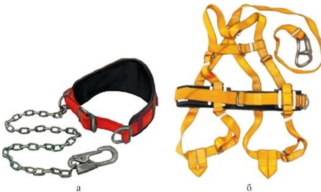
Рис. 25.7. СИЗ от падения с высоты: а - пояс монтерский, модель ПМ-Н. Предназначен для обеспечения безопасности работ на высоте и опорах. Пояс комплектуется отстегивающимся стропом из капронового каната, ленты или цепи. Величина обхвата талии - 800-1500 мм. Статическая разрывная нагрузка - 15 кН; б - пояс предохранительный, модель ППАЖ. Пояс предохранительный с наплечными и набедренными лямками. Предназначен для проведения работ на высоте и на опорах
